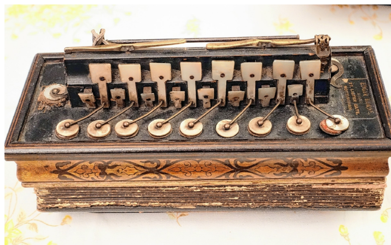
Gut sichtbar: Metallzungen-Mechanik bei frühem Akkordeon.
